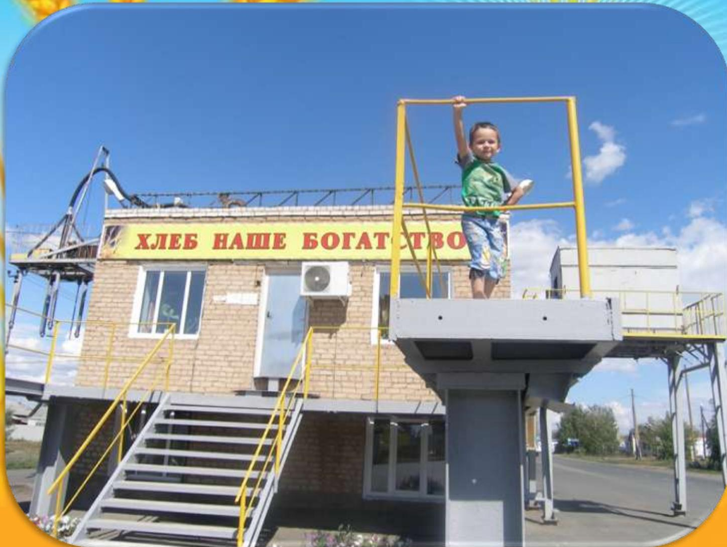
Здесь производится отбор образцов зерна с автотранспорта в пробосборник, который вы видите рядом со мной.
